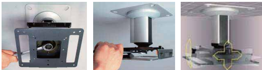
一箇所のボルト操作でプロジェクターの角度調整ができます。(前後方向:前傾30度/後傾3度 左右方向:3度 回転:360度)
